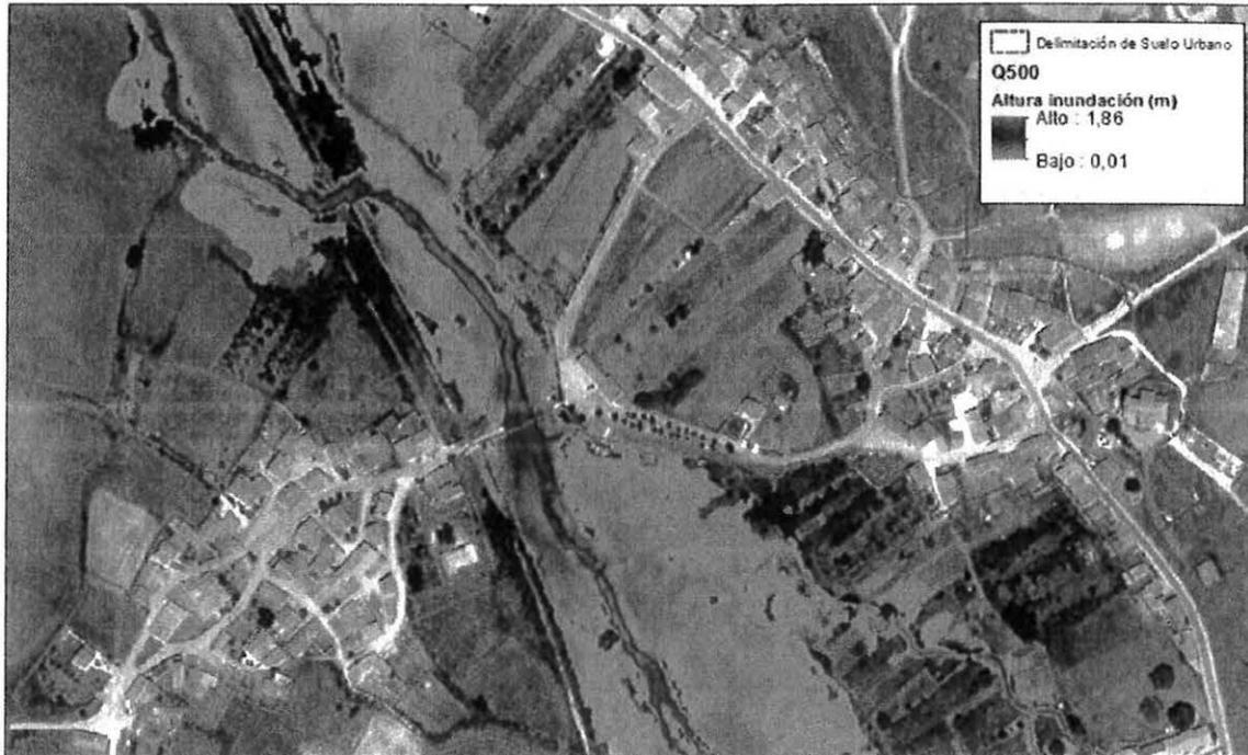
Imagen n°3: Resultados del estudio hidráulico realizado con modelo bidimensional ( $Q_{500} = 15 \text{ m}^3/\text{s}$ )
